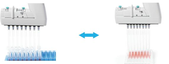
Дозаторы с регулируемым расстоянием между наконечниками, рассчитанные на 384-луночный формат
