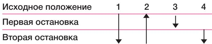
«Да»: Дозирование образцов или реагентов без смещивания с другой жидкостью.
