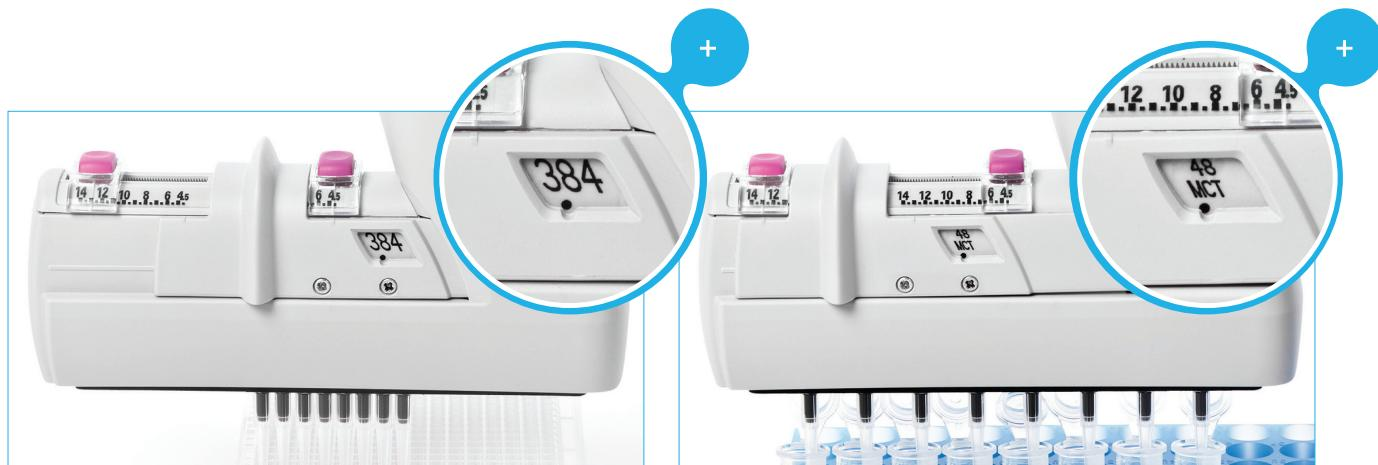
В окошке бегунка установлено значение «384» для переноса дозатором проб на 384-луночный микропланшет
